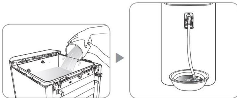
6. Откройте клапан подачи исходной воды. Включите систему в сеть, подождите пока система наполнится водой и включите нагрев и охлаждение.
