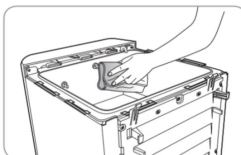
5. Для мытья накопительной емкости используйте чистую воду, которую слили ранее. После мытья залейте оставшуюся воду обратно в систему и закройте крышки емкости и системы в обратном порядке. Слейте воду через слив еще раз.
