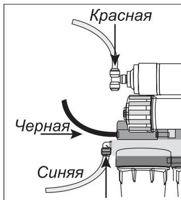
При наличии в фитинге-тройнике заглушки предварительно извлеките ее. Вставьте свободный конец ЧЕРНОЙ пластиковой трубки в фитинг ограничителя потока водоочистителя. Вставьте свободный конец БЕЛОЙ пластиковой трубки в фитинг на выходе 5-й ступени очистки. При наличии в фитинге заглушки предварительно извлеките ее.
